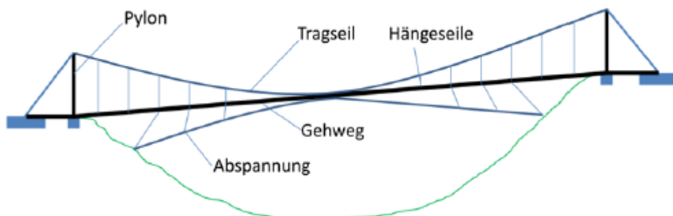
Abbildung 6: Prinzipschema Hängebrücke (Basler & Hofmann, 2015)
